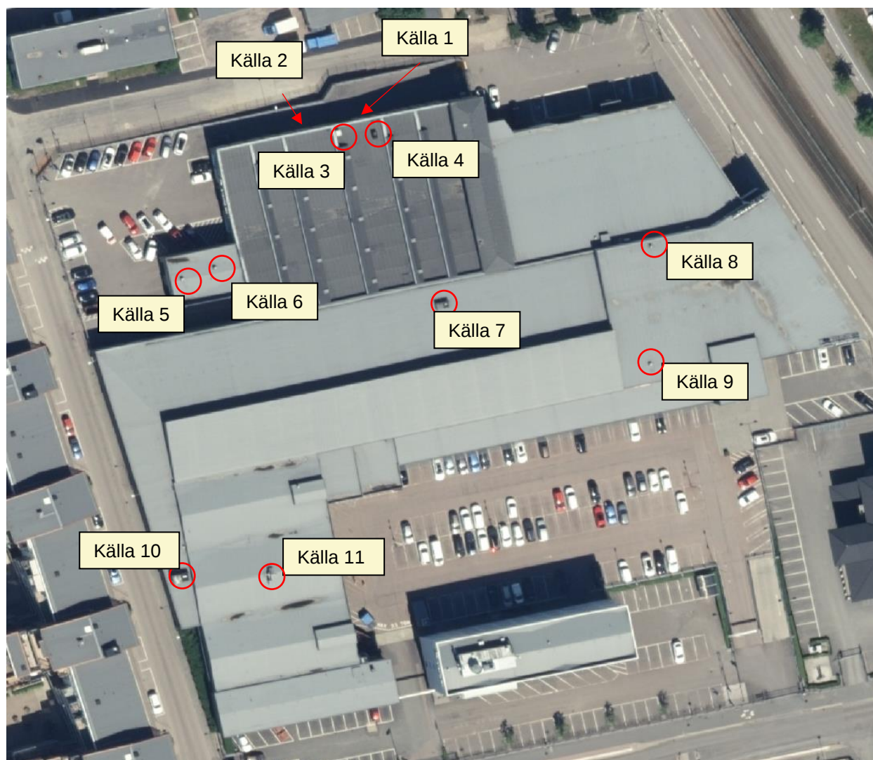
Figur 2. Inventerade bullerkällor på taket till Hedin Bils byggnad
